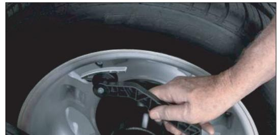
Mätarmen har ett fäste för klistervikter, med hjälp av detta kan vikterna monteras på exakt rätt ställe efter balanseringen och slutresultatet blir korrekt vid första försöket
